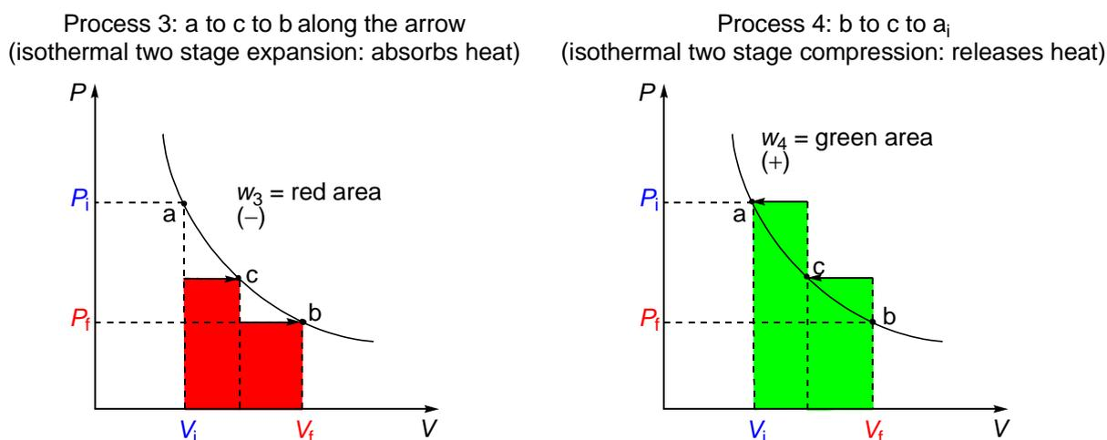
按照這個模式，從 a 走到 b 分成三階段，返回亦然，不可逆環狀路徑放出的熱會更少；也就是說，分的階段愈多，放出的熱愈少。最終極的狀況是分成無限個階段，也就是說膨脹時每一階段的外壓只降低無限的一點點，經過無限長的時間之後，系統幾乎等同於沿著那條黑色的  $PV$  曲線從 a 經過 c 走到 b。折返時也是分成無限個階段，也就是說壓縮時每一階段的外壓只增高無限的一點點，經過無限長的時間之後，系統幾乎等同於沿著那條黑色的  $PV$  曲線從 b 經過 c 走回到 a。這一條路徑稱為可逆環狀路徑(reversible cyclic process)，因為是沿著同一條路徑過去並回來。
